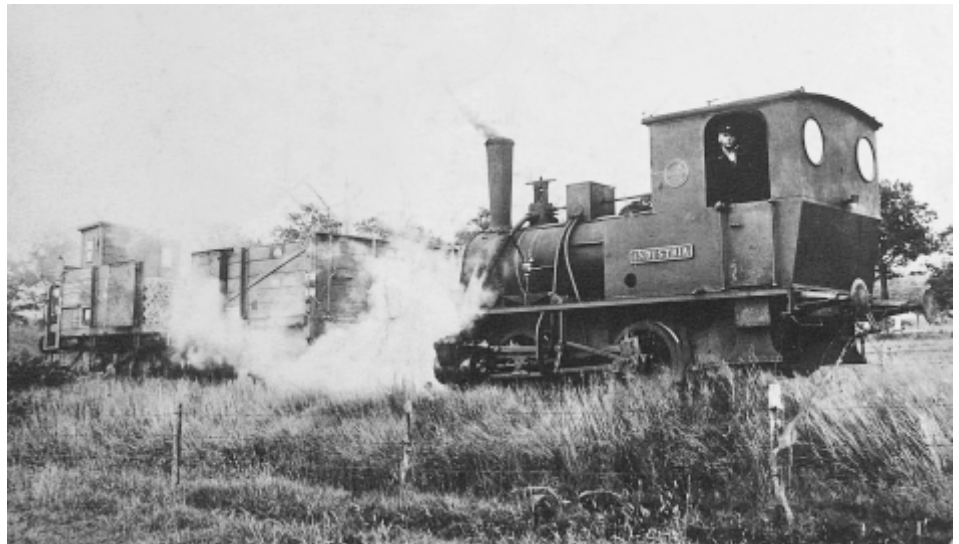
Unter Dampf! Lokführer Weyer mit seiner Dampflokomotive und einem Waggon voll Ziegelsteinen auf dem Anschlußgleis unterwegs zur Strecke Bocholt-Wesel. Auf dem Waggon kann man durch die geöffnete Luke die Ziegelsteine erkennen. Um Beschädigungen an den Steinen zu vermeiden, wurden die Steine im Zick-Zack System auf den Waggons verpackt. Die Lok war eine typische Industrielok für Werksbahnen, am Waggon erkennt man an der Stirnseite noch ein Bremserhäuschen.
